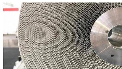
Il foglio di alluminio viene sgrassato chimicamente e rivestito su entrambi i lati con un'innovativa formulazione igroscopica e un pretrattamento anticorrosione. La formulazione è
